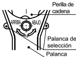
1. Mueva la palanca de selección hasta la posición neutral ('N') como se muestra en la ilustración de la izquierda.
