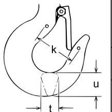
\* Estos valores son nominales ya que la dimensión no es controlada con respecto a una tolerancia. La dimensión "k" se debe medir cuando el gancho es nuevo – esto se convierte en una medición de referencia. Las subsecuentes mediciones se comparan con esta referencia para tomar la determinación acerca de la deformación o alargamiento del gancho. Consulte la Sección 4.5, "Ganchos - Alargamiento".
