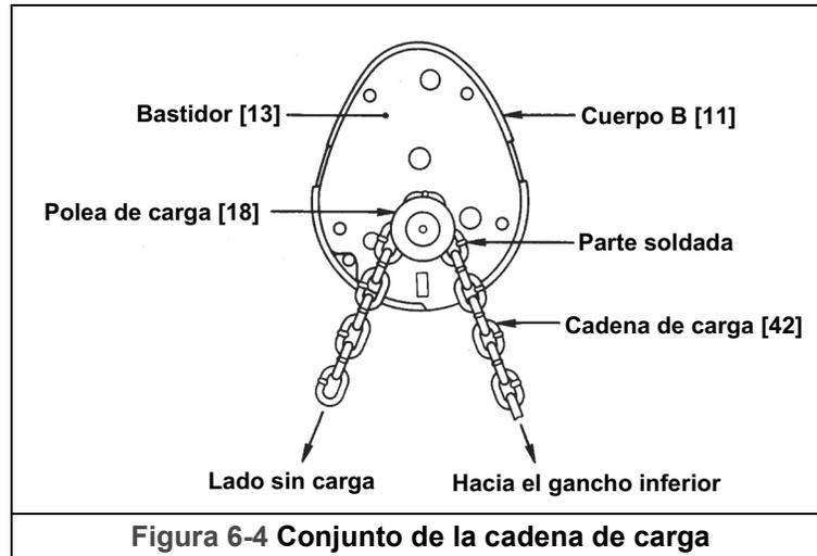
**Figura 6-4 Conjunto de la cadena de carga**
