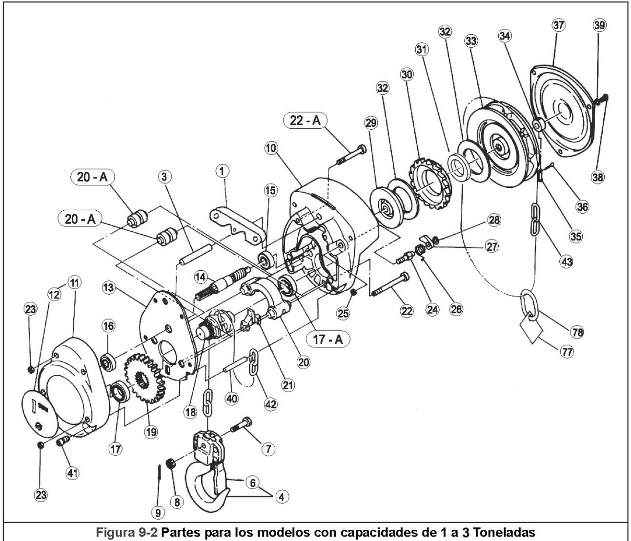
Figura 9-2 Partes para los modelos con capacidades de 1 a 3 Toneladas
