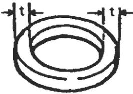
**Buje [31] t: Espesor radial**
