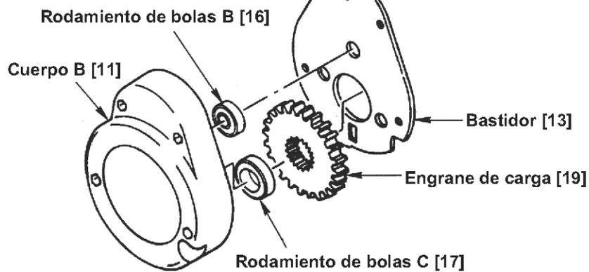
**Figura 5-4 Conjunto del engrane de carga**
