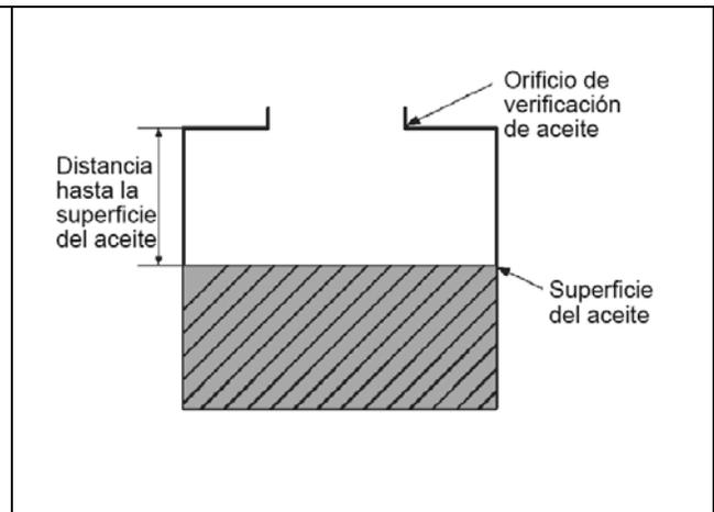
**Figura 6-3** Distancia para verificación del aceite del engranaje
