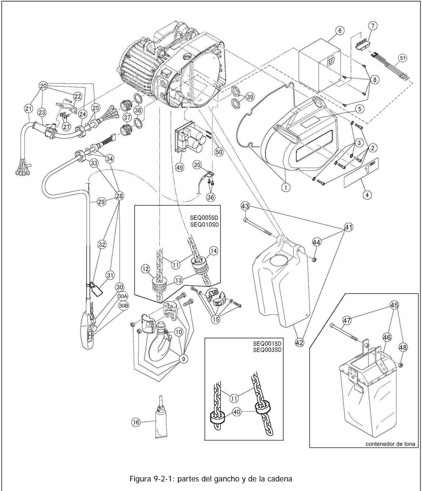
Figura 9-2-1: partes del gancho y de la cadena
