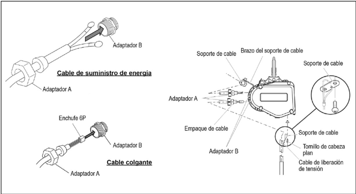
**Figura 3-7** Conexiones de cable de botonera y cable de suministro de energía
