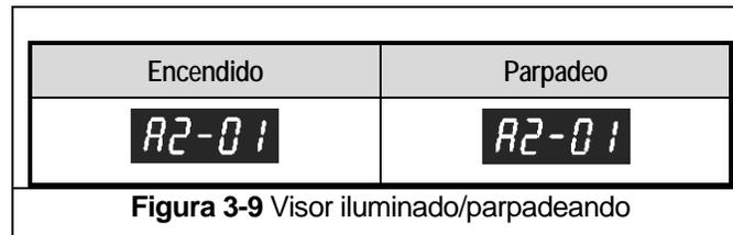
3.6.7 El visor digital usa un carácter de siete segmentos para formar los caracteres específicos que se usan en el visor. La **Tabla 3-3** muestra los caracteres digitales correspondientes a su equivalente en inglés.
