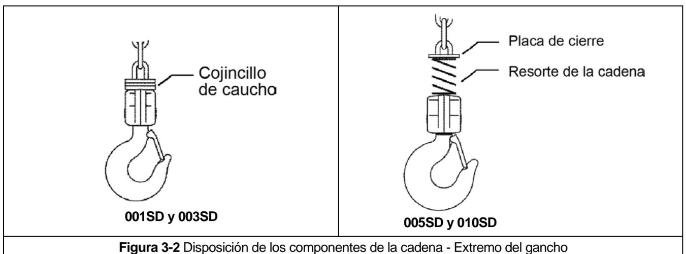
\*Torsión de ajuste para los pernos de la articulación del gancho: 19,6 N-m (14,5 lb-ft) para 001SD, 003SD y 005SD
