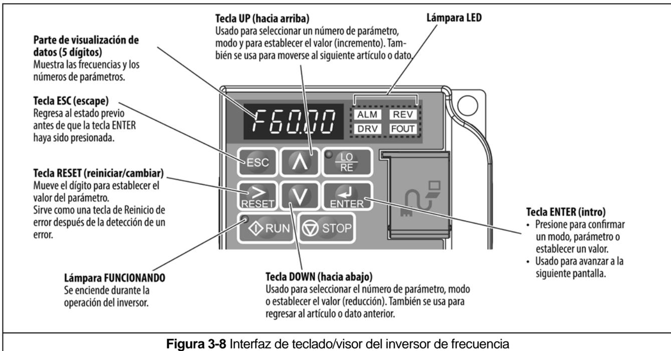
**Figura 3-8** Interfaz de teclado/visor del inversor de frecuencia
