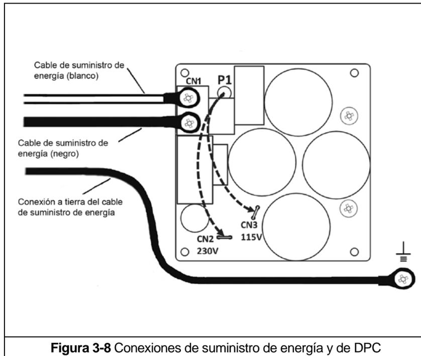
**Figura 3-8** Conexiones de suministro de energía y de DPC
