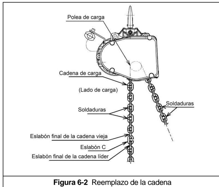
**Figura 6-2** Reemplazo de la cadena
