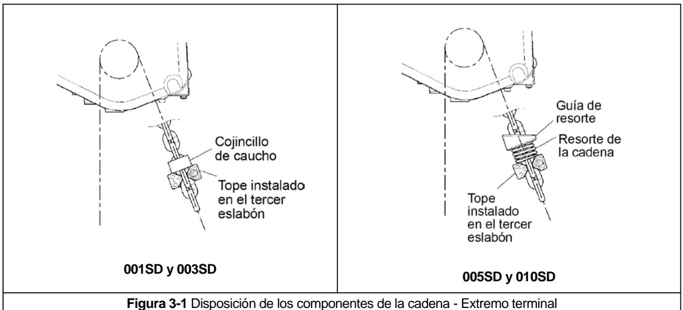
\*Torsión de ajuste para el perno del conjunto de tope: 10,8 N-m (8,0 lb-ft)
