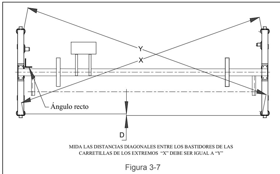
Realice los ajustes que sean necesarios. Después apriete de manera segura cada conexión sujeta de los bastidores de la carretilla del extremo hasta la viga del puente. Consulte los valores de la torsión de apriete en la Tabla 3-1.
