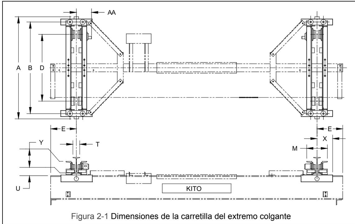
Figura 2-1 Dimensiones de la carretilla del extremo colgante
