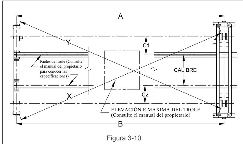
Realice los ajustes que sean necesarios. Después apriete de manera segura y coloque una doble tuerca en cada conexión sujeta, del bastidor de la carretilla del extremo hasta la viga del puente. Consulte los valores de la torsión de apriete en la Tabla 3-1.
