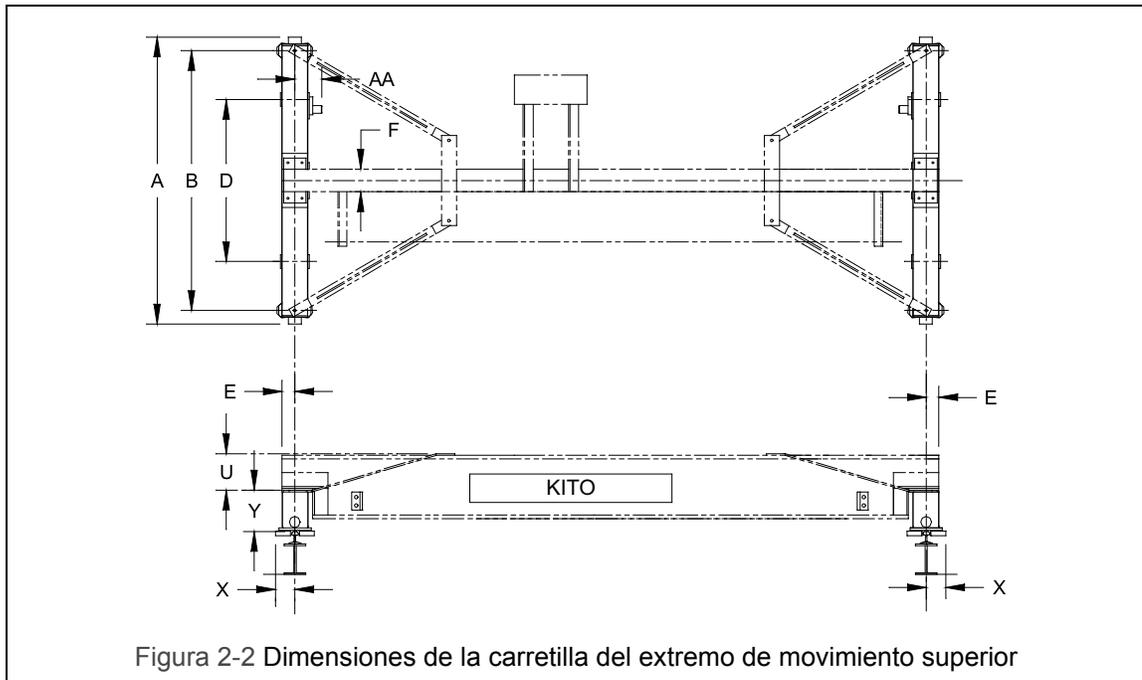
Figura 2-2 Dimensiones de la carretilla del extremo de movimiento superior
