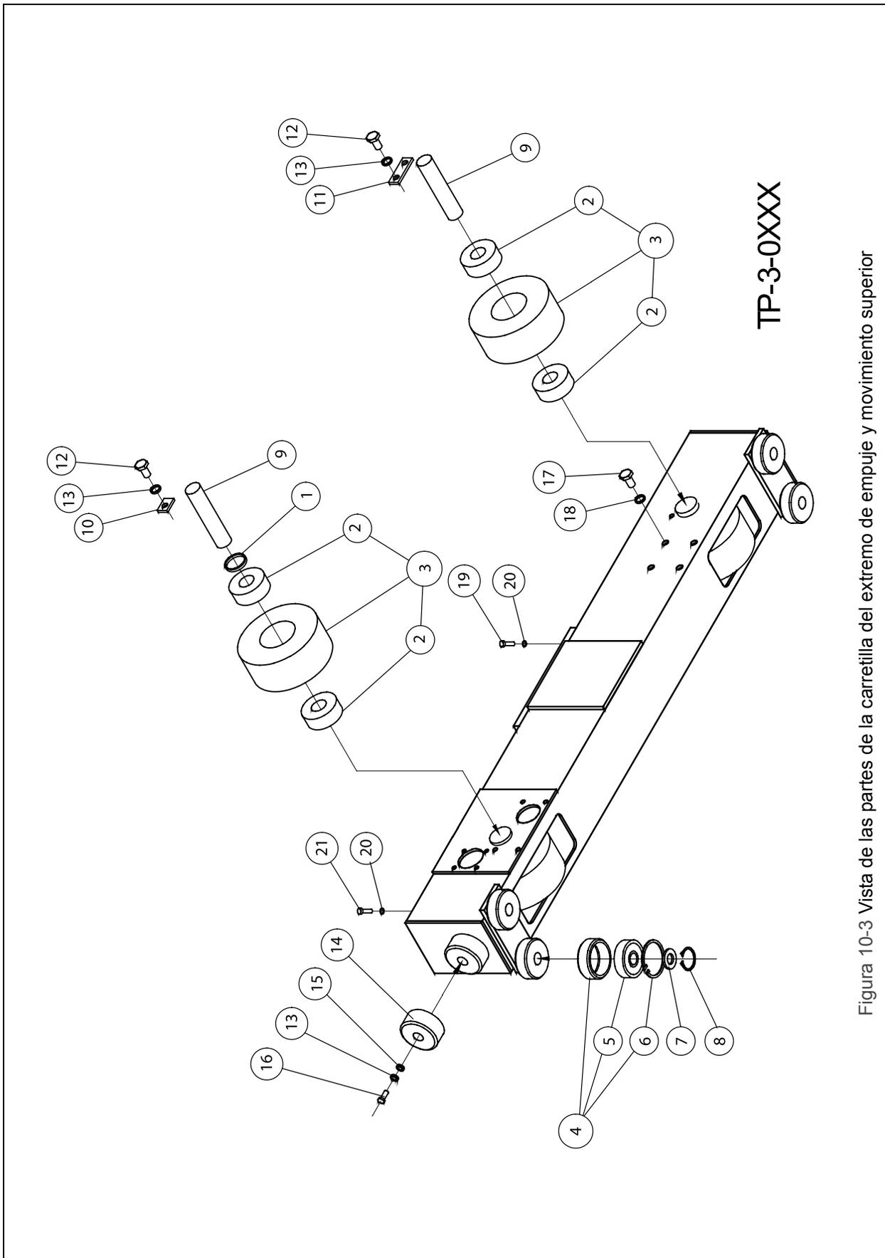
Figura 10-3 Vista de las partes de la carretilla del extremo de empuje y movimiento superior
