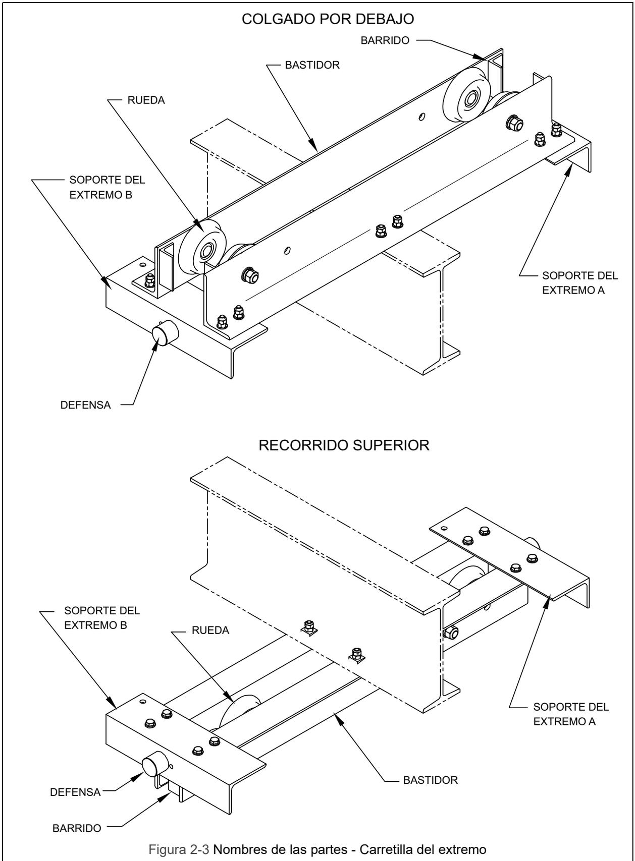
Figura 2-3 Nombres de las partes - Carretilla del extremo
